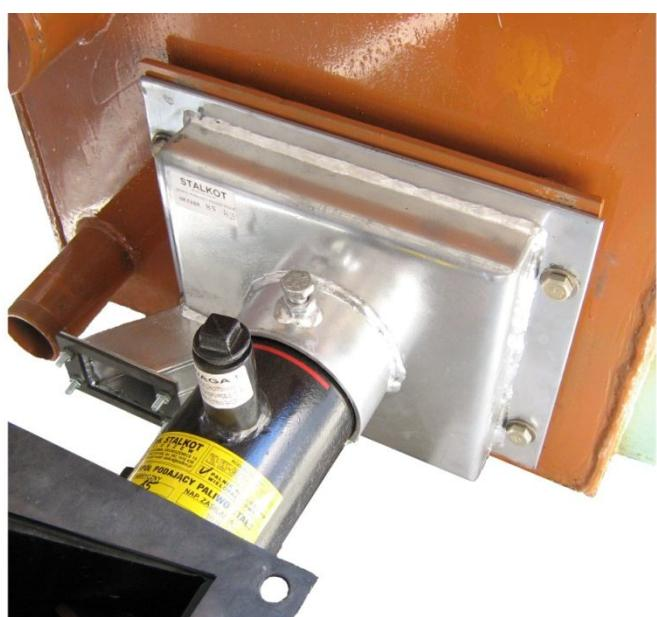
Рисунок 3 – Место установки механизма подачи топлива
