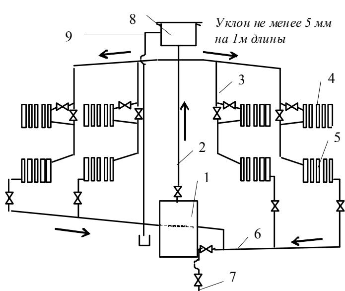
1 - котел; 2 - главный стояк; 3 - стояки; 4,5 - нагревательные приборы 1 и 2-го этажа; 6 - трубопровод обратной воды; 7 - подпиточный водопровод; 8 - расширительный бак; 9 - переличная труба.
