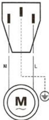
Рисунок 8 – Схема подключения проводов циркуляционного насоса
