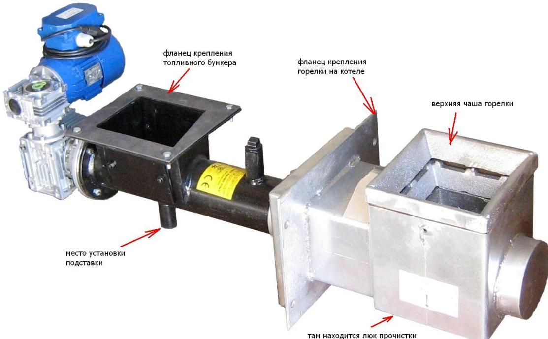
Рисунок 2 – Внешний механизм подачи топлива
