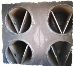
Рисунок 4 – Схема установки турбулизаторов
