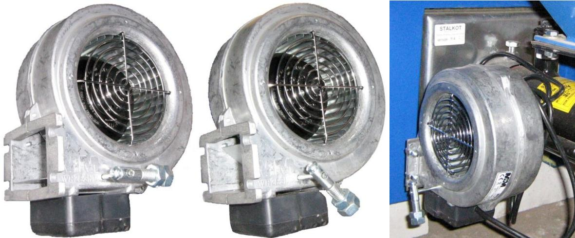
Рисунок 6 – Регулировка положения заслонки вентилятора
